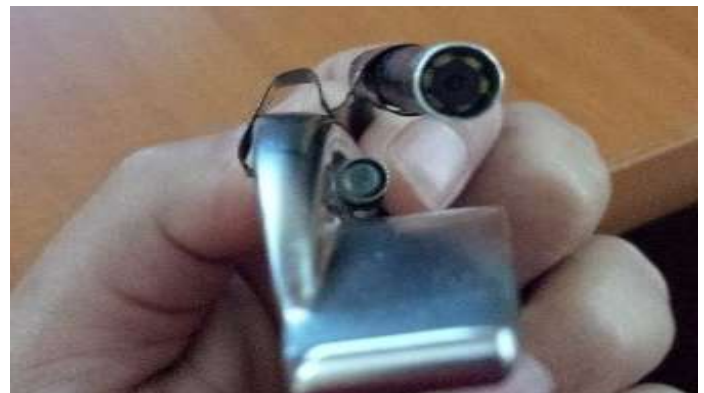
Figura 1. Colocación de Cámara mediante el broche adaptador
